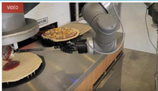
Le robot est capable de préparer 100 pizzas à l'heure. Il fonctionne dans un local entièrement automatisé de 50 à 60 mètres carrés, vitré pour permettre au public de le voir. Les clients commandent leurs pizzas sur place ou via une application, et les prennent toutes prêtes dans une boîte, dans un casier qui s'ouvre automatiquement.
